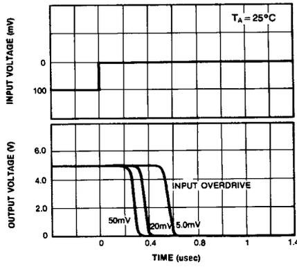
Fig. 5 RESPONSE TIME FOR VARIOUS INPUT OVERDRIVE-POSITIVE TRANSITION
