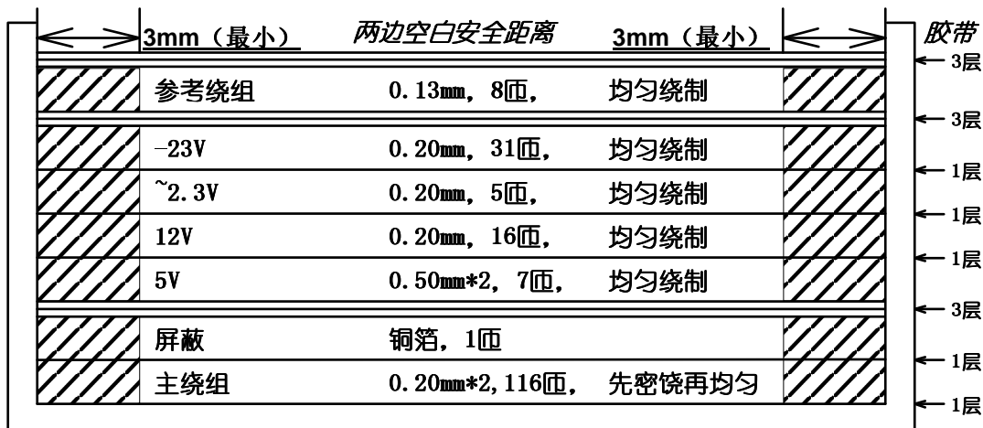
图 5、例 2，T1,EEL19,1mH 变压器结构
