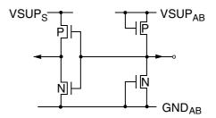
Fig. 6-29: Input pins P42-P46
